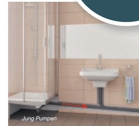
Vorher: Das Duschwasser fließt in freiem Gefälle aus der hohen Duschwanne in das Abwasserrohr in der Wand.
